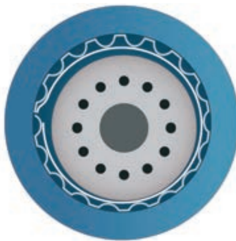
Obr. 2: Díky systému vzduchových ložisek, společnost AERZEN nabízí levné, jednoduché a spolehlivé řešení pro hřídelová ložiska turbodmychadel
