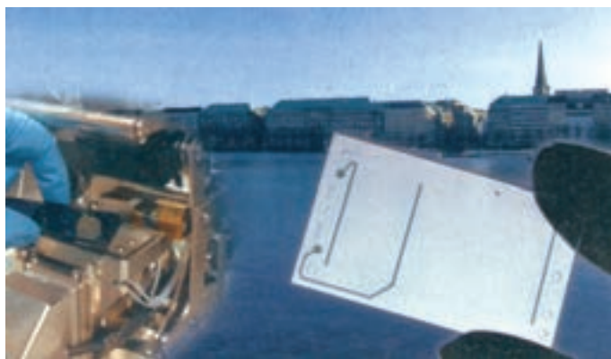
Obr. 3b: Systém lab-on-chip pro extrakci choroboplodných zárodků
