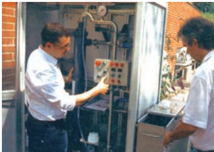
Obr. 3a: Start testovacího provozu prvního stupně systému pro zkoncentrování vzorku vody u Berlínských vodovodů v červnu 2014
