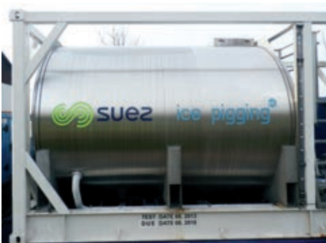
Obr. 1: Přepravní cisterna s připravenou ledovou tříští o objemu 10 m 3
