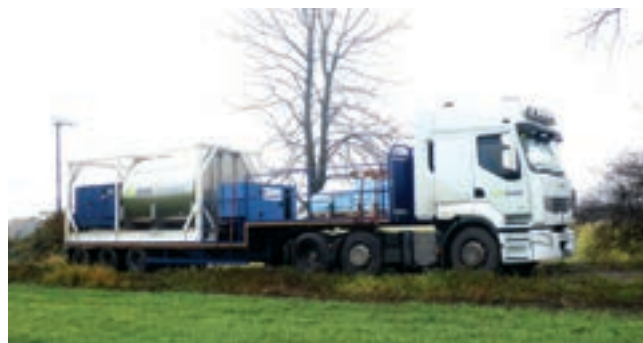
Obr. 4: Mobilní jednotka na dodávku ledové tříště je umístěna na kamionu
