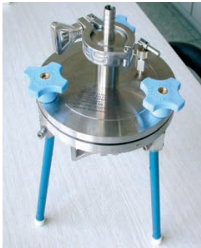
Obr. 1: Nerezový držák filtrů pro diskové filtry o průměru 90 a 142 mm, Merck (Stainless Steel Filter Holder for 90 and 142 mm disc filters)
