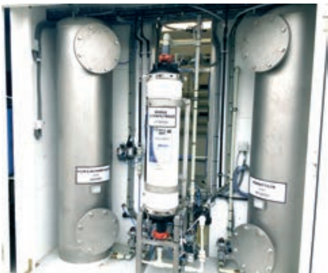
Obr. 4: Písková filtrace, membránová filtrace a filtr s granulovaným aktivním uhlím v poloprovozní jednotce pro recyklaci odpadních vod
