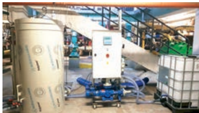
Obr. 5: Poloprovozní jednotka provozovaná v rámci projektu Zlepšování kvality stabilizovaných kalů metodou post-aerace
