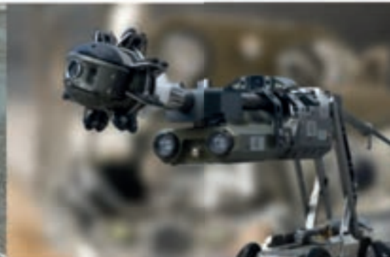
Diagnostika podzemních potrubí kamerovým systémem
