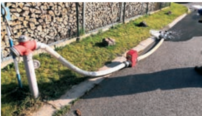
Obr. 4: Jedna z variant sestavy pro zkoušení hydrantů
