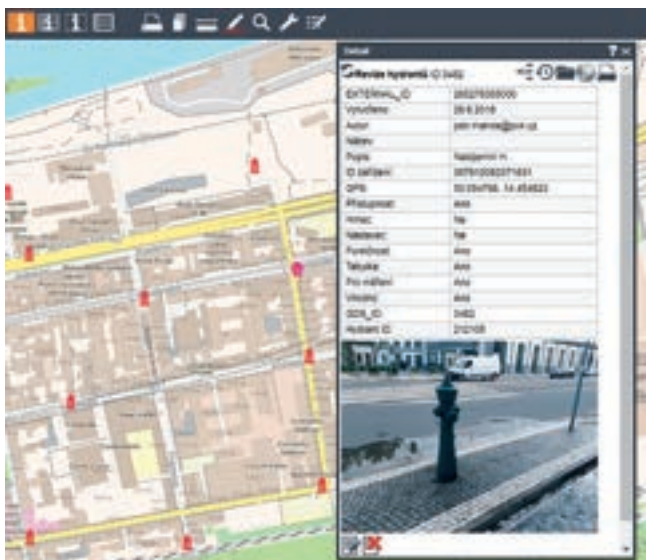
Obr. 3: Zjištěné údaje včetně foto jsou součástí GIS
