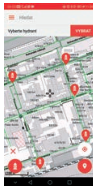
Obr. 2: Mobilní GIS se zobrazenými hydranty ke kontrole
