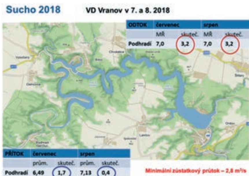
Obr. 5: Ukáзка situace přítoku a odtoku z nádrže Vranov v letních měsících v r. 2018 (porovnání dlouhodobých měsíčních průměrů a hodnot z manipulačního řádu s aktuální situací v uvedených měsících). Zdroj: Povodí Moravy, s. p.
